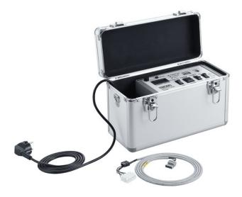
Para a colocação em funcionamento e parametrização dos motores de janela IQ windowdrive
